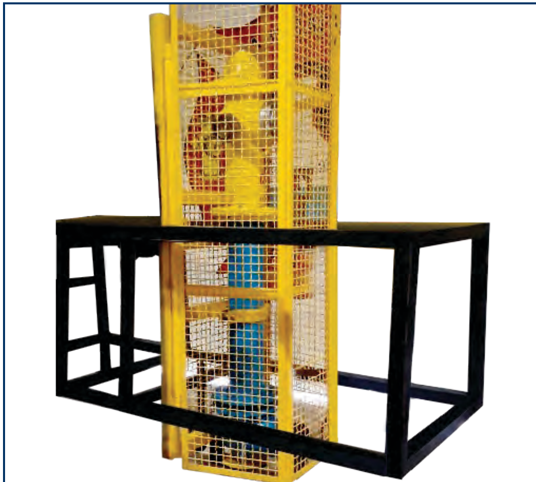
آزمون تخلیه خودکار هیدرانت Automatic hydrant drainage test
